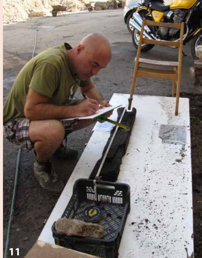
11 — měřičská a kresbová dokumentace konstrukčních prvků v měřítku 1:10; 12 — snímkování pomocí dronu probíhalo pravidelně každý druhý týden; 13 — 3D skenování zkoumané plochy; 14 — terénní dokumentace základové partie mladšího mostu; 15 — digitalizovaný plán stejné vertikální konstrukce s doprovodným kontextem; 16 — 3D sken vrcholné uli podzemí gotického okna z obytné části tvrze (1. pol. 15. století)
