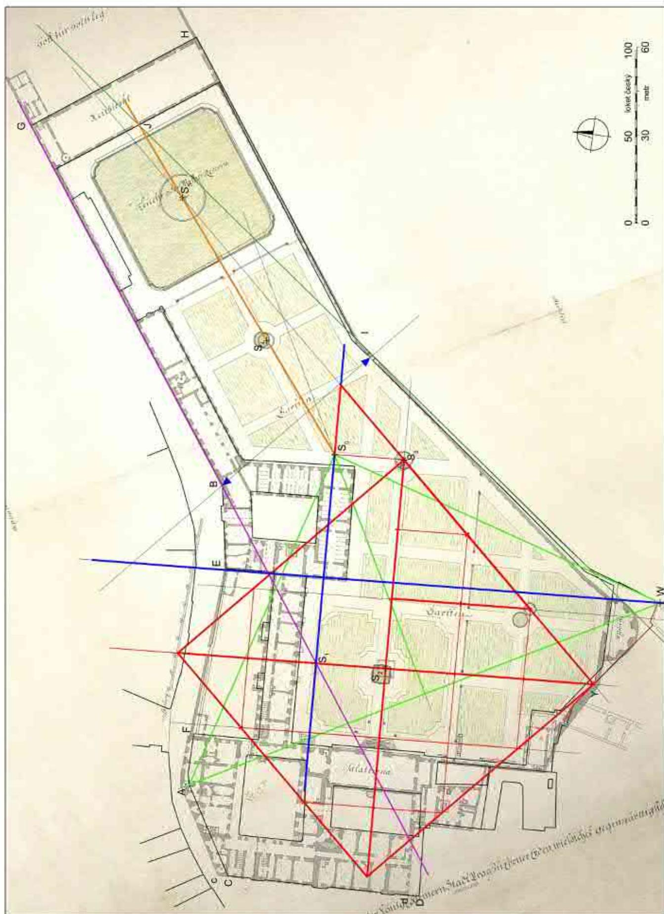
Obr. 8: Soutisk plánu přízemí Valdštejnského areálu od Anselma Luraga z roku 1753 (sedlá, zelená) s obrýsem hmot Valdštejnského areálu z Technické mapy 1 : 500 (černé linie) a s barevným schématem základního konstrukčního řešení areálu. (Autor M. Müller, dig. provedení M. Durtca.)
