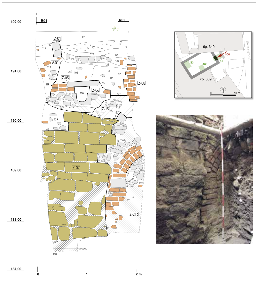
Obr. 8. Praha 1-Staré Město, Bartolomějská čp. 309, sonda S1, řez R4. Exteriérový líc východní obvodové zdi románského domu. Nadzemní zdivo tvořeno pravidelnými kvádry, základové zdivo tvoří ve spodním úseku lomová opuka, nad ní 4 řádky z méně pečlivě otesaných nepravidelných kvádrů. Vpravo část ve vrcholném středověku prořazeného cihlového portálu (kresba J. Sedláčková a N. Trachtová; foto J. Sedláčková, 2012; grafická úprava S. Babušková, 2014).
