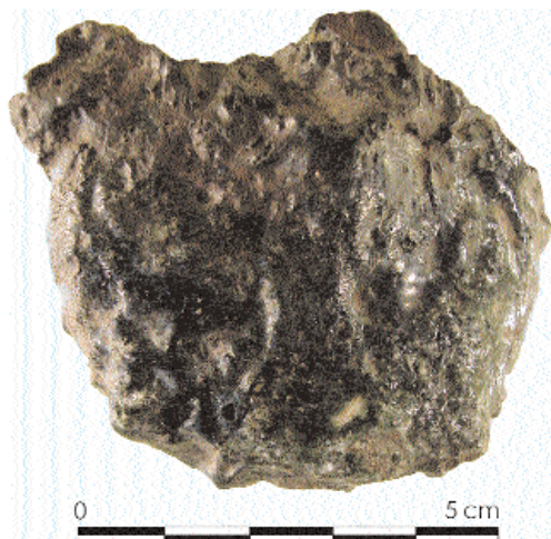
Obr. 18: Struska vzniklá při paleometalurgické činnosti – výrobě bronzu (sáček 10/97–256). Fig. 18: Slag produced during a palaeometallurgical work – bronze making (find bag 10/97–256).
