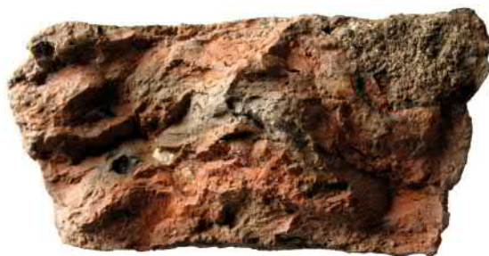
Obr. 13 Patrný rozdíl mezi prohnětenou červenou a šedou masou cihlářské hlíny s úlomky kamenů a zbytky vegetace a tenkými hnědavými, drobně ostřenyými plátky kvalitního keramického těsta lemujícího základní masu po obvodu na lomu dlaždice R 177. Foto: M. Müller
